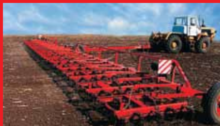
LIRA Tanjirače sa oprugama sa širokim radnim zahvatom, hidraulične
