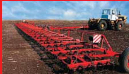
LIRA Erpici a denti vibranti (a molla) idraulici e con grande larghezza di lavoro
