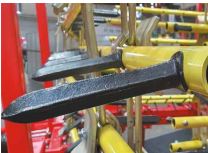
Высокопрочный ромбовидный зуб
