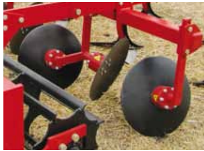
Лесно регулиране на дълбочината на обработване
