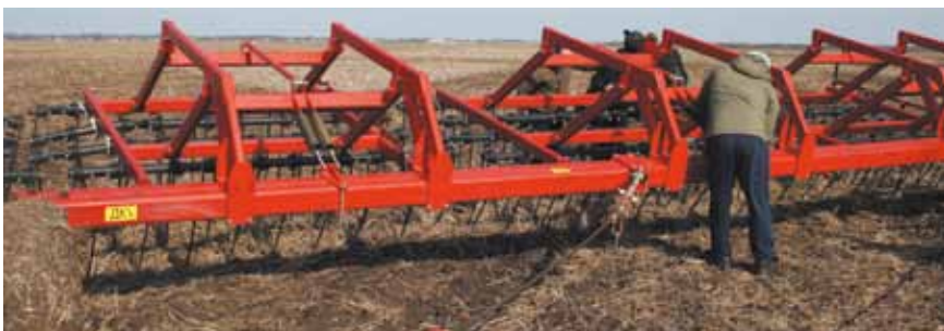
Дърпане на секции с помощта на въже
