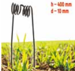
ЛИРА ЗЪБОПРУЖИННА БРАНА
